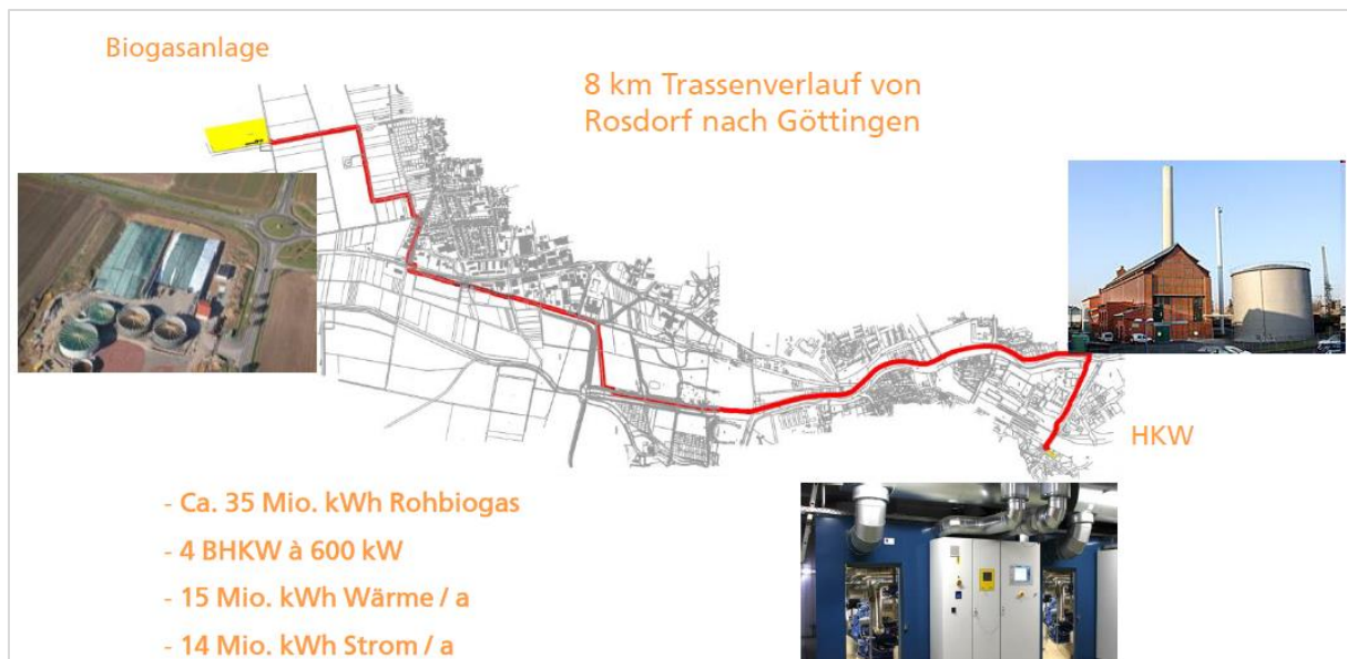
Abbildung 19: Versorgung des Heizkraftwerks (HKW) der Stadtwerke mit Biogas
